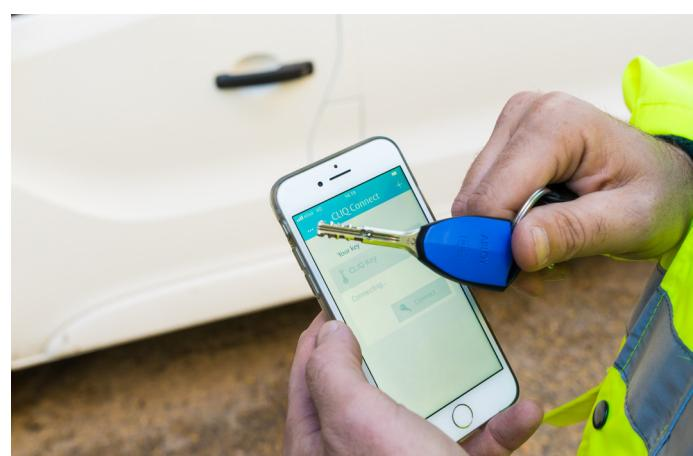
**"Toute l'énergie se situe dans la clé. Il n'y a pas d'alimentation dans la serrure et donc très peu de maintenance. Des cylindres électromécaniques et mécaniques sont gérés par une clé unique."**
